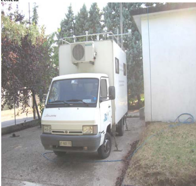
Stazione rilocabile ARPAV per i monitoraggi dell'aria nell'area della concia
